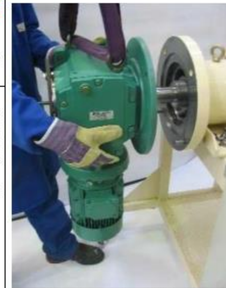
Démontage du bloc motoréducteur
